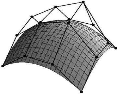
Hình 4. Mặt tự do hình thành theo lưới điểm điều khiển 4x4
